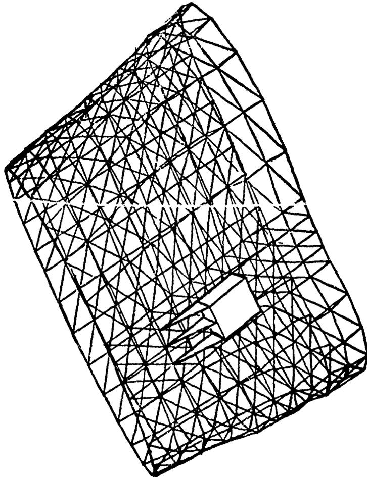
FIGURE 4-20 FINITE ELEMENT MODEL OF SRB FORWARD SKIRT
