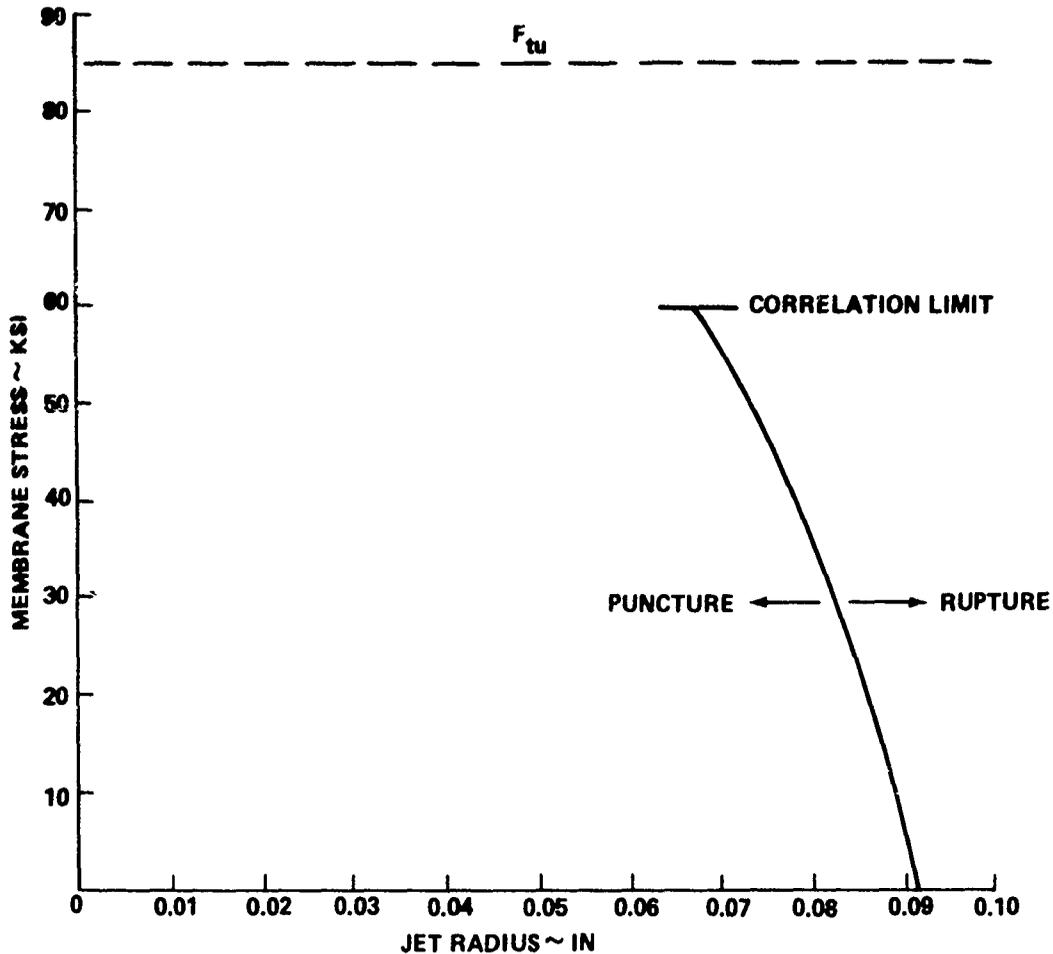
FIGURE 4-63 MINIMUM JET RADIUS TO RUPTURE LOX TANK
