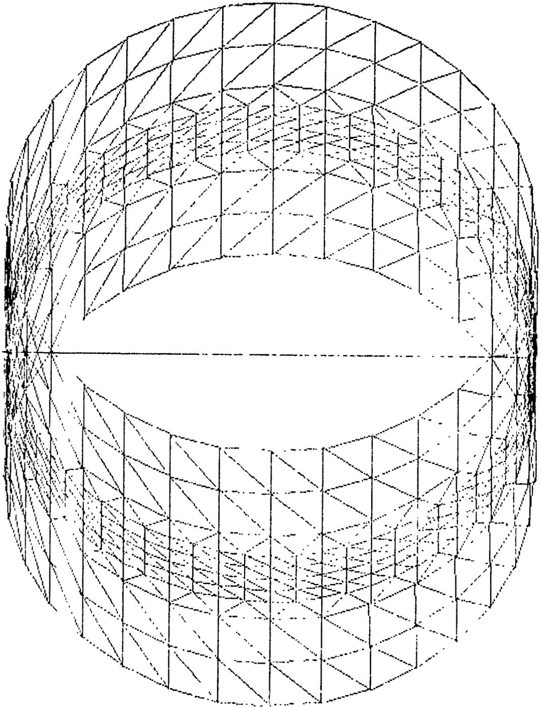
FIGURE E-5 FINITE ELEMENT MODEL OF INTERTANK
