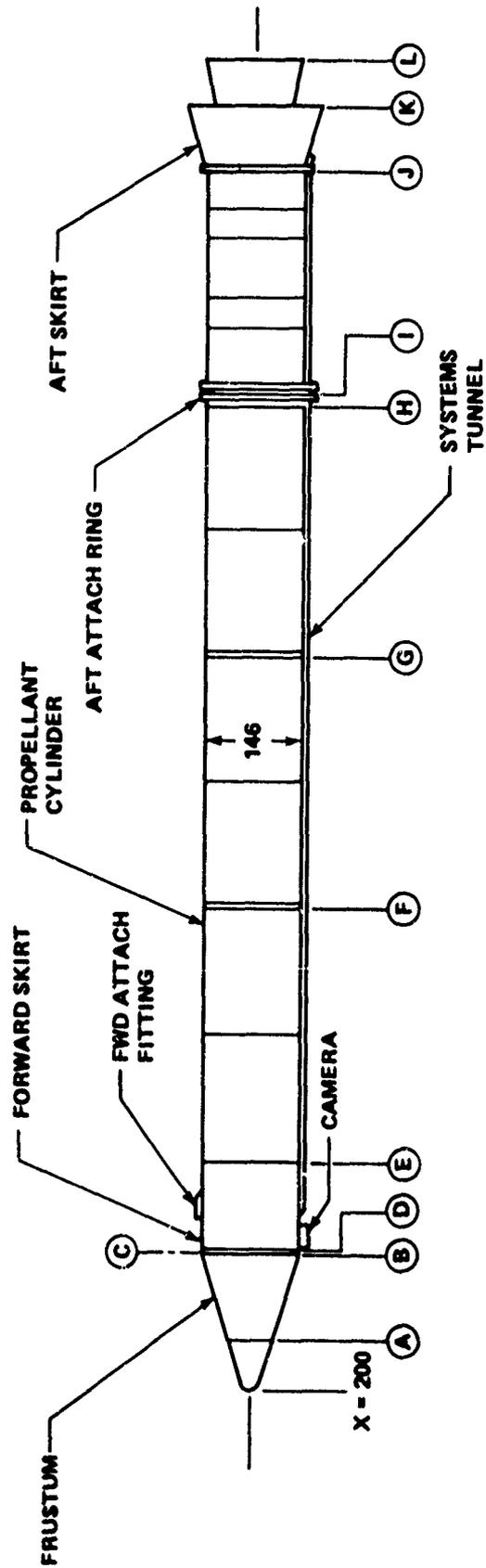
FIGURE F-1 COMPONENTS - SOLID ROCKET BOOSTER
