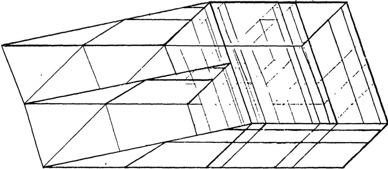
FIGURE F-8 FINITE ELEMENT MODEL OF THRUST POST FITTING
