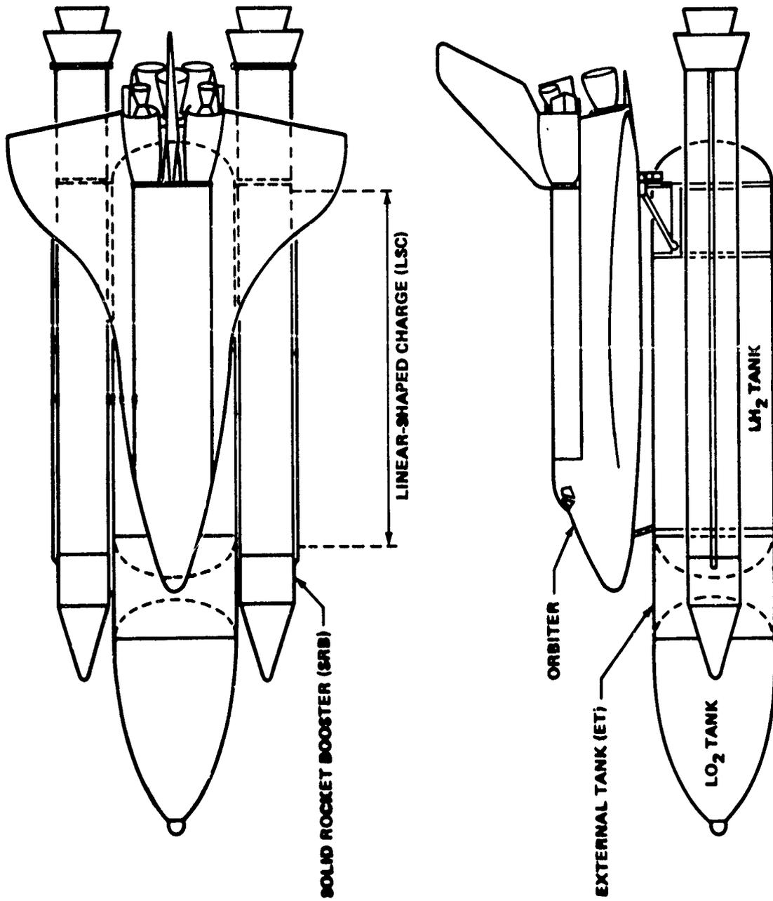
FIGURE 2-1 SPACE SHUTTLE CONFIGURATION
