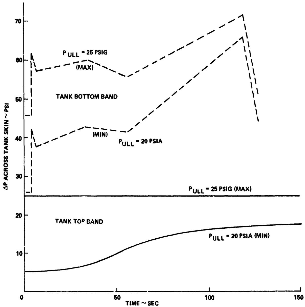
FIGURE 4-59 LOX - ΔP VS. FLIGHT TIME
