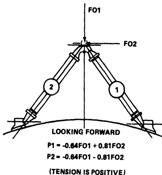
FIGURE 4-78 FORWARD ORBITER JOINT COMPONENT AND ATTACH FITTING LOADS
