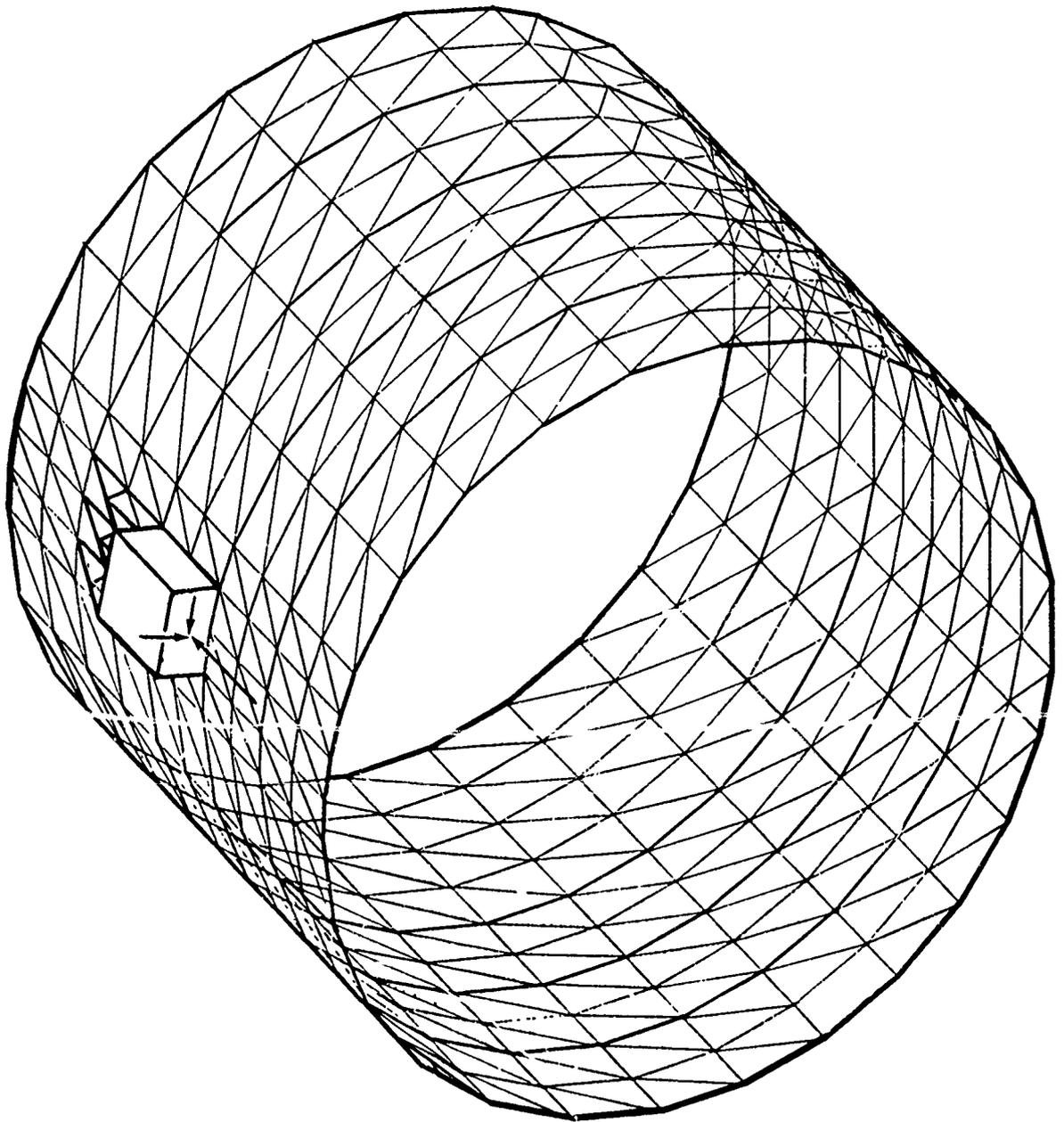
FIGURE F-5 FINITE ELEMENT MODEL OF FORWARD SKIRT
