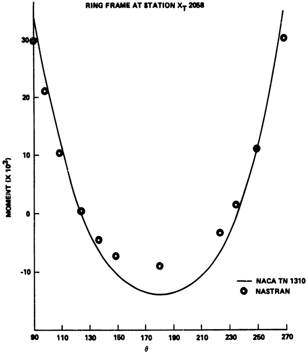
FIGURE C-6 TEST CASE — BENDING MOMENT DISTRIBUTION
