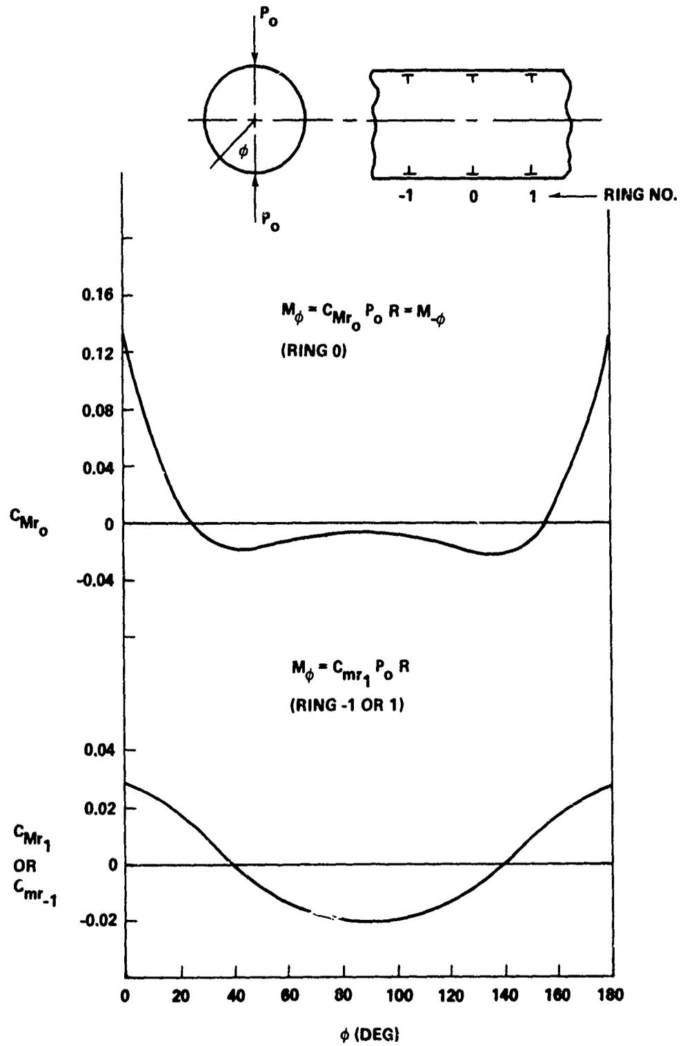
FIGURE I-4 RING-BENDING MOMENT COEFFICIENTS
